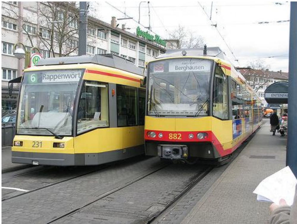
Abbildung 0-1 Niederflur- und Zweissystemwagen des KVV
