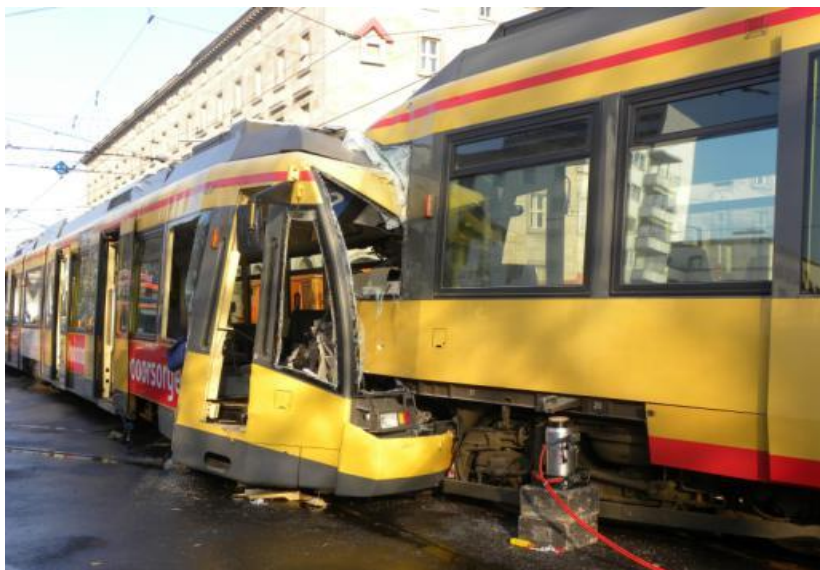
Abbildung 1-2 Deutlich zu erkennen, wie die "höhere" Stadtbahn in die "niederere" Straßenseite gefahren ist.
